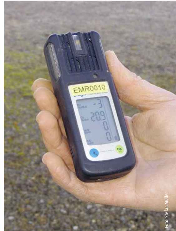
Gaswarngerät – überlebenswichtiger Begleiter der Streckenkontrolleure.
